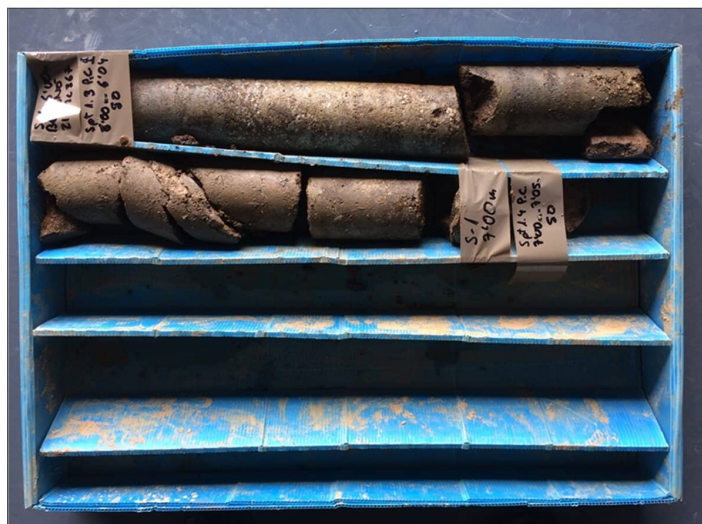
Foto 5: Material perforat entre 6 m i 7 m a S1.
