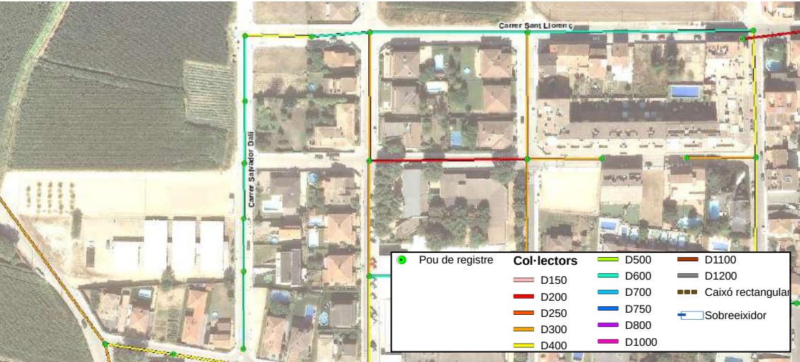
Figura 2. Traçat de la xarxa de clavegueram dels carrers de Salvador Dalí i Sant Llorenç
