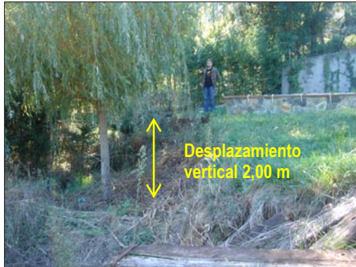
Fig. 5. Desnivel topográfico en la cabecera del talud. P-704. Fig. 6. Vista del la cicatriz de coronación.
