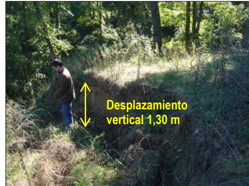
Fig. 5. Desnivel topográfico en la cabecera del talud. P-704. Fig. 6. Vista del la cicatriz de coronación.
