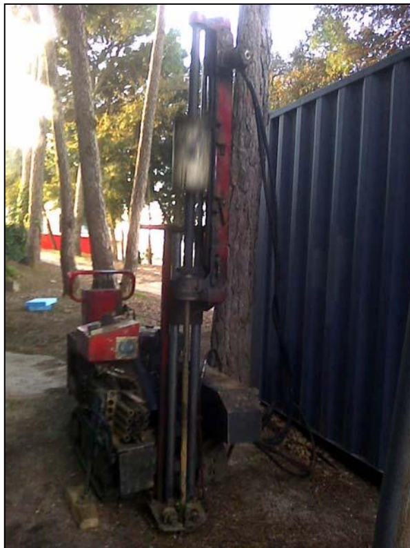
Foto 4: Assaig de penetració dinàmica PD-1.
