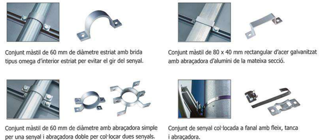
Figura 91. Sistemes de subjecció plaques d'alumini.
