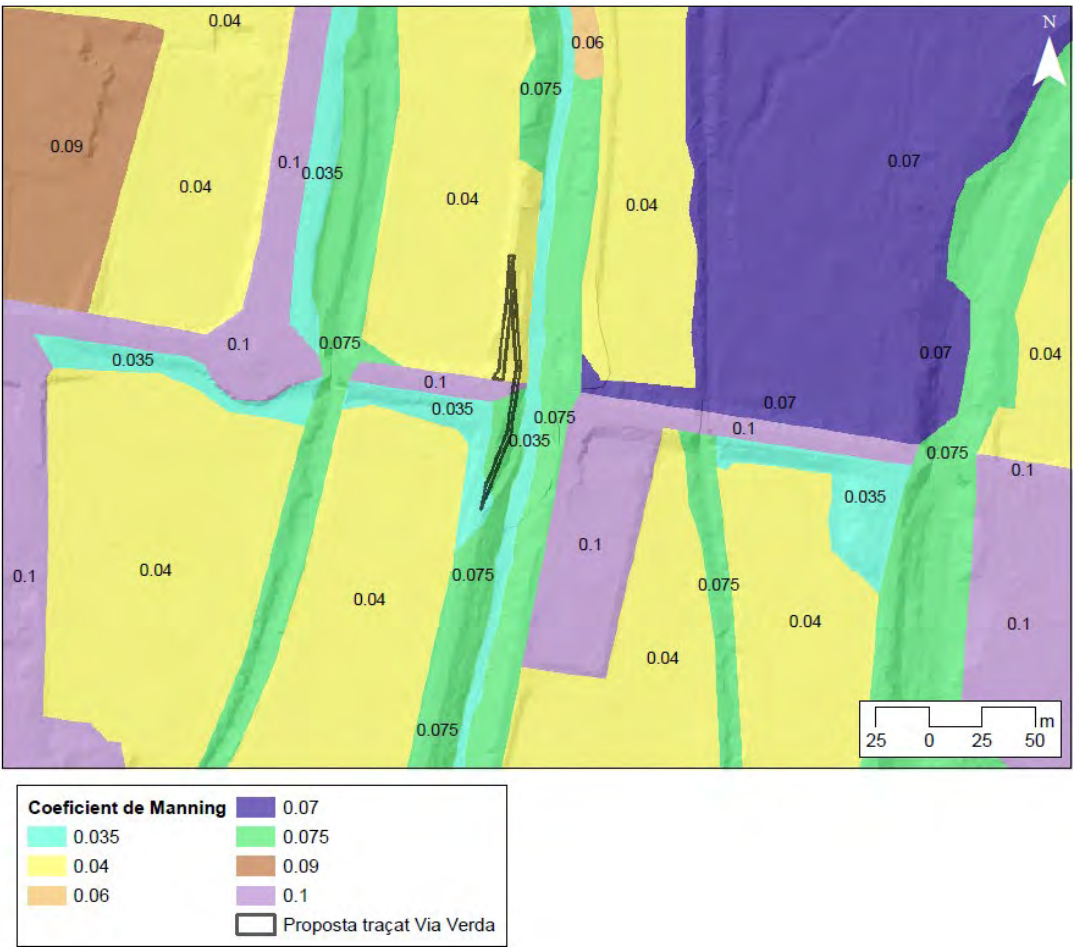
Imatge 6. Coeficients de Manning del model
