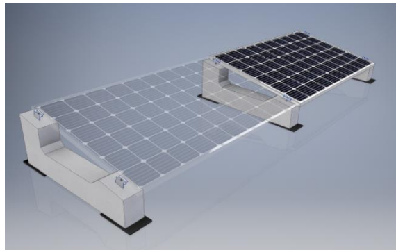
Figura 3. Representació de l'estructura i subjecció dels mòduls
