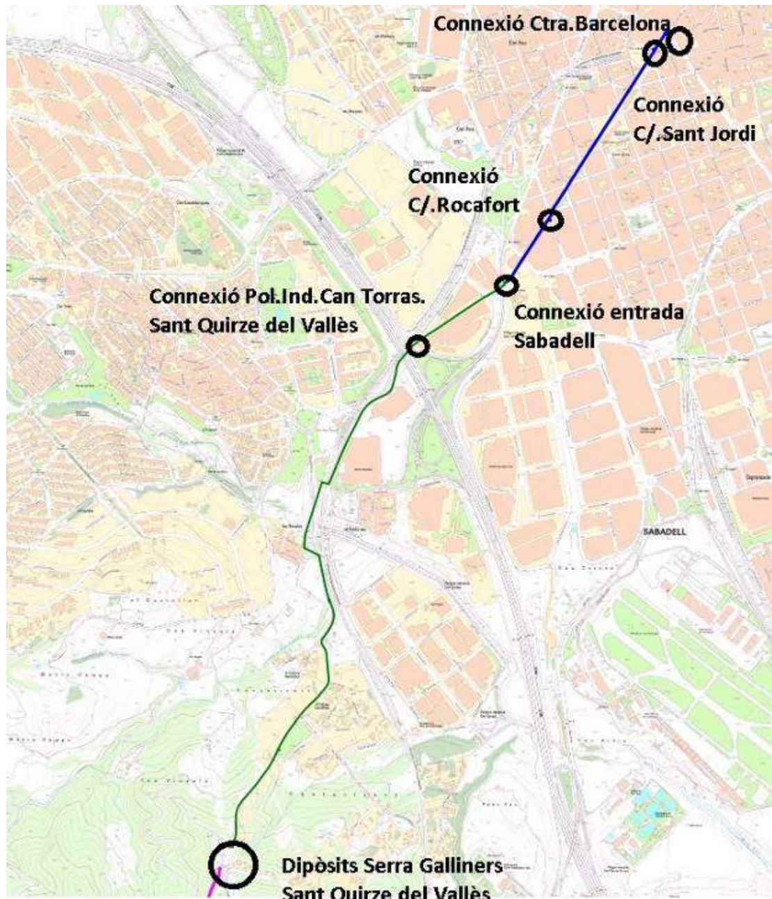
Plànol 5. Traçat de la canonada des del Dipòsit de Serra Galliners a Sant Quirze del Vallès fins a la connexió de la Ctra. Barcelona a Sabadell
