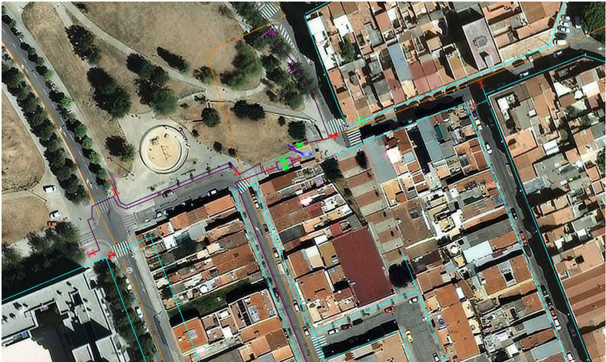
Plànol 28. Emplaçament i connexions a xarxa d'aigua potable dipòsit Nàpols (Ribatallada)
