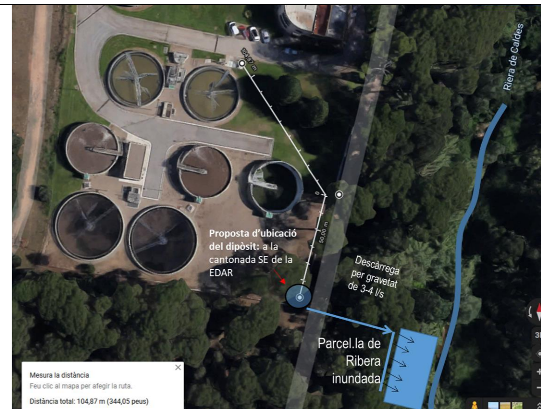
Exemple de gestió d'aigües provinents d'efluent de depuradora (EDAR).
