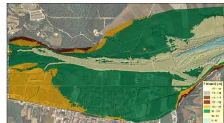
Model digital d'elevacions utilitzat en la modelització del riu Ter
