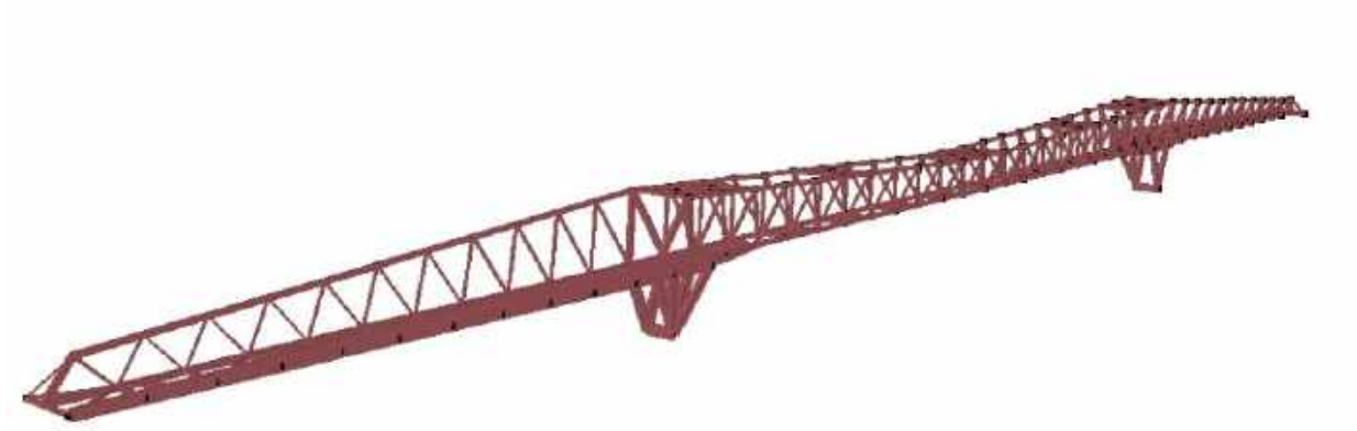
Tipologia estructural projectada.
