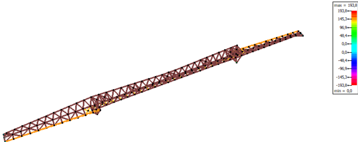
3.1.23 Reacció &s en punto (kN) - Vent
