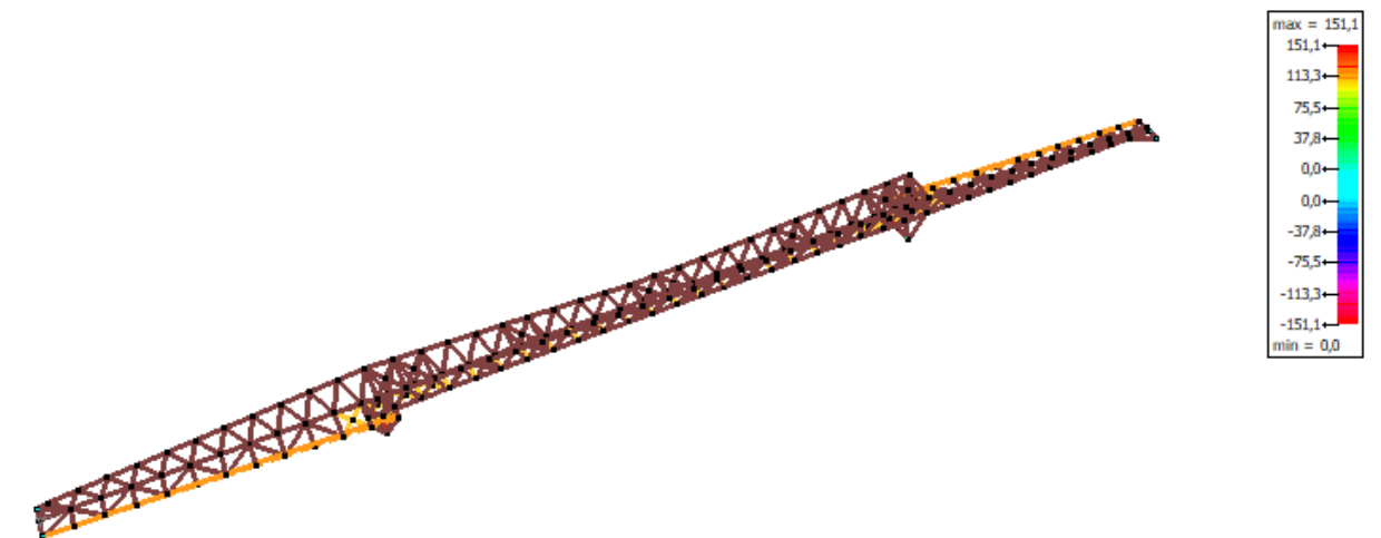
3.1.22 Reacció &s en punto (kN) - Sísmica
