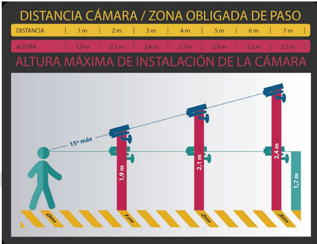
Recomendaciones del ángulo sobre horizontal de cámaras para identificación
