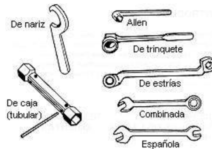
Fig. 3: Tipos de llaves de boca fija
