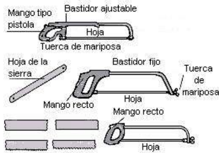
Fig. 12: Partes y tipos de sierras de arco
