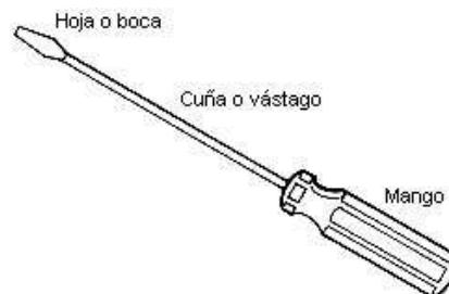
Fig. 11: Partes de un destornillador
