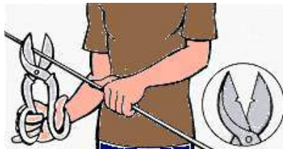
Fig. 15 Utilización incorrecta de tijeras con hojas melladas
