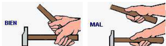
Fig. 6: Forma de sujeción del mango
