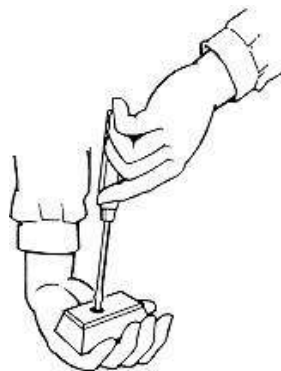
Fig. 14: Sujeción incorrecta de una pieza a atornillar
