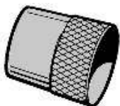
Fig. 4: Cuña anular para asegurar la unión de la cabeza con el mango
