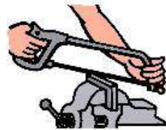
Fig. 13: Pieza fijada firmemente antes de serrar
