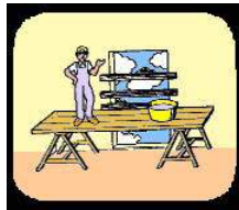
Fig. 16: Andamio situado junto a una abertura en una pared protegida
